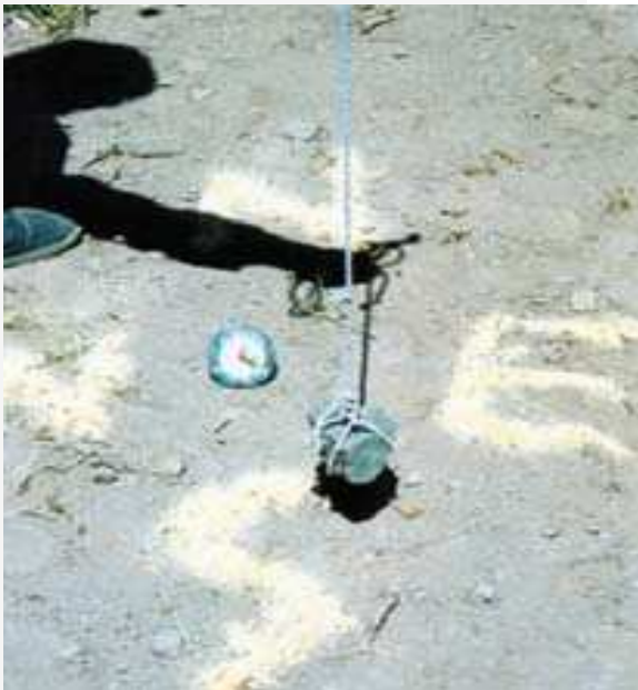
Figura 27: Determinar el sur con una plomada
